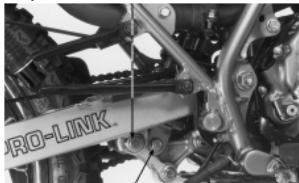
PARAFUSO DE FIXAÇÃO INFERIOR
