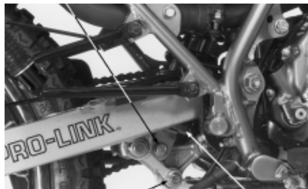
PARAFUSO ENTRE O BRAÇO DO AMORTECEDOR E A HASTE DE CONEXÃO
