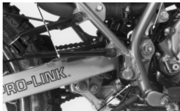
PARAFUSO DE FIXAÇÃO DO BRAÇO DO FREIO
