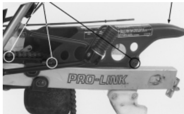
PARAFUSO ENTRE A HASTE DE CONEXÃO E O BRAÇO OSCILANTE
