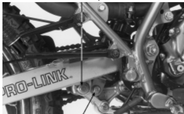
PARAFUSO DE FIXAÇÃO INFERIOR PARAFUSO ENTRE A HASTE DE CONEXÃO E O BRAÇO OSCILANTE
