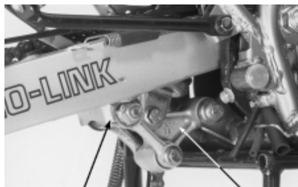
HASTE DE CONEXÃO BRAÇO DO AMORTECEDOR
